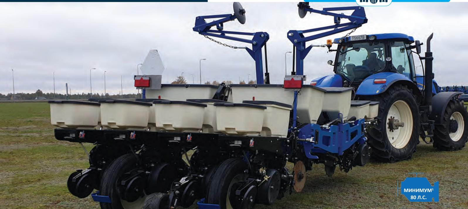
Сеялка Kinze 3035 представляет собой модель с малой транспортной шириной и широким функционалом, идеально подходящую многим фермам, где малая ширина в положении для транспортировки имеет критически важное значение для движения по узким дорогам или выезда на небольшие поля. Конструкция двойной рамы со складными крыльями позволяет использовать оборудование для внесения жидких или сухих удобрений, делая сеялку максимально универсальной при небольших размерах.
