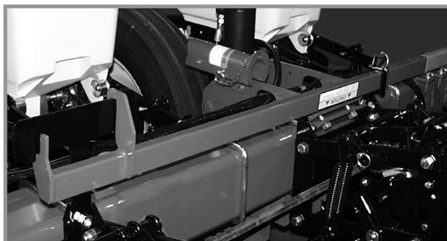
Лост за повдигане в позиция за съхранение
