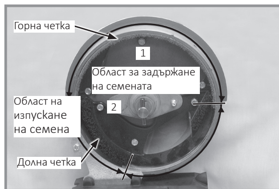
Монтиране на горна четка
