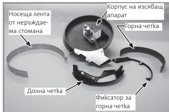
Части на изсяващ апарат тип четка
