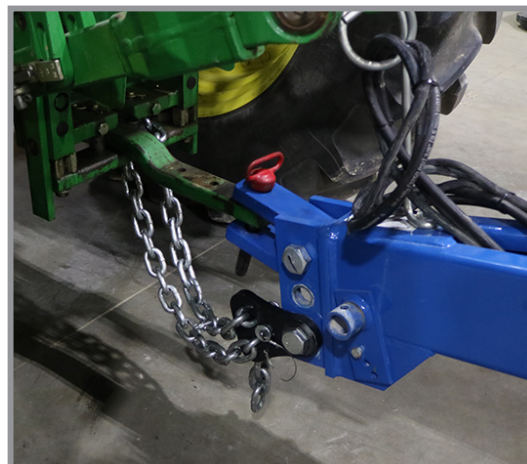
Свързване на теглич и предпазна верига
