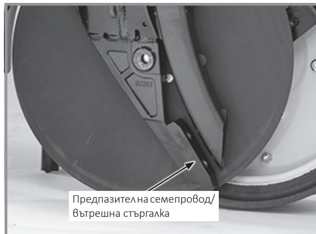
Показана със свалено габаритно колело и дисков нож на лемеж
