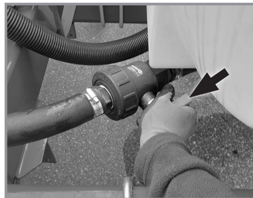
Клапан на резервоара за тор
