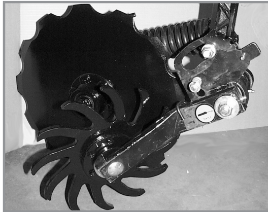
Приставка на колело за стърнища на назъбен едnodисков лемеж
