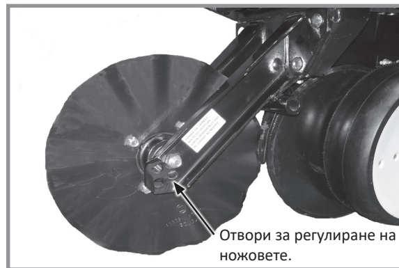
Монтиран за сееща секция предплужник за нулева обработка
