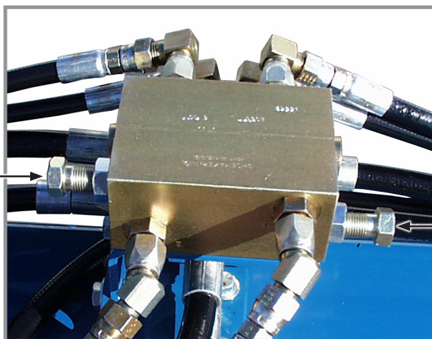
Клапани за контрол на дебита на маркера
