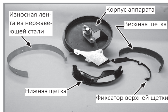
Детали щеточного высевающего аппарата
