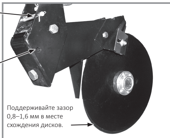
Двухдисковый сошник для внесения удобрений
