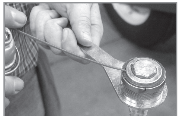
Змащування важеля з витою пружиною
