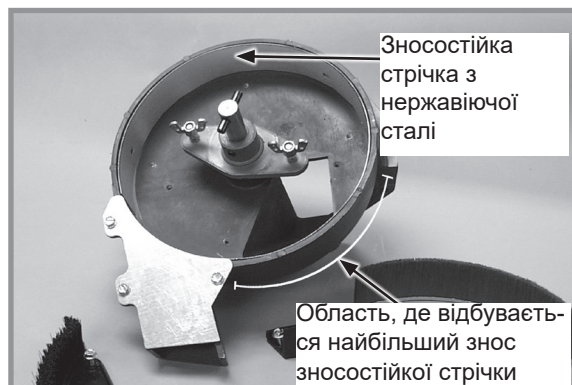
Зносостійка стрічка з нержавіючої сталі
