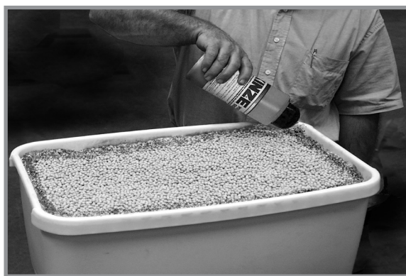
Додавання графіту до стандартного бункера
