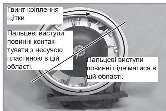
Правильна робота пальчикового висівного апарату
