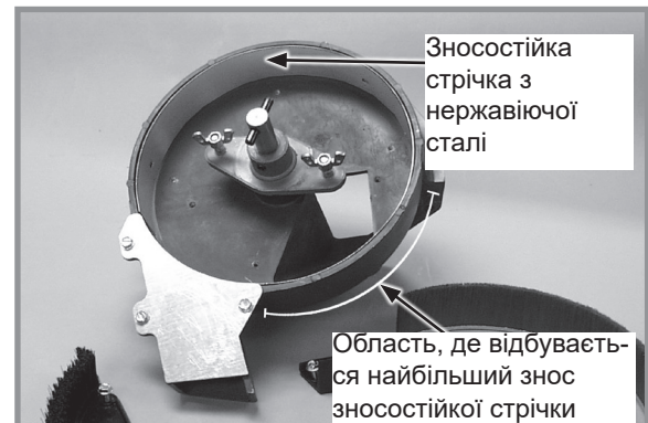
Зносостійка стрічка з нержавіючої сталі
