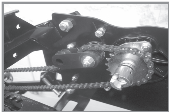
Привід механічного висівного апарату фронтальної висівної секції
