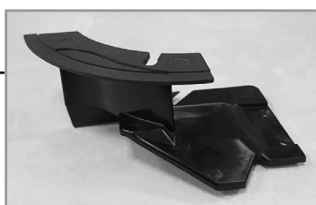
Місце встановлення прокладки на роздільнику
