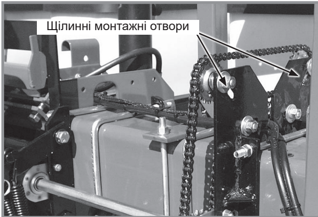
Регулювання натягу ланцюга приводу роздільного висіву
