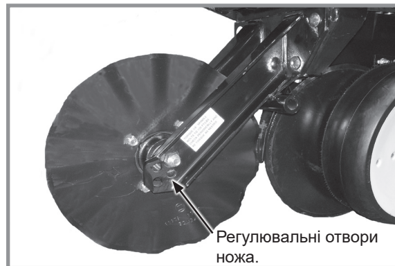
Дискові ножі для нульової обробки ґрунту, що встановлюються на висівні секції
