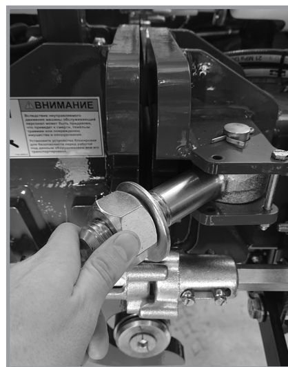
Фиксирующий крыло болт с кольцом
