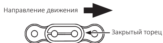
Привод вакуумного высевающего аппарата задней высевающей секции
