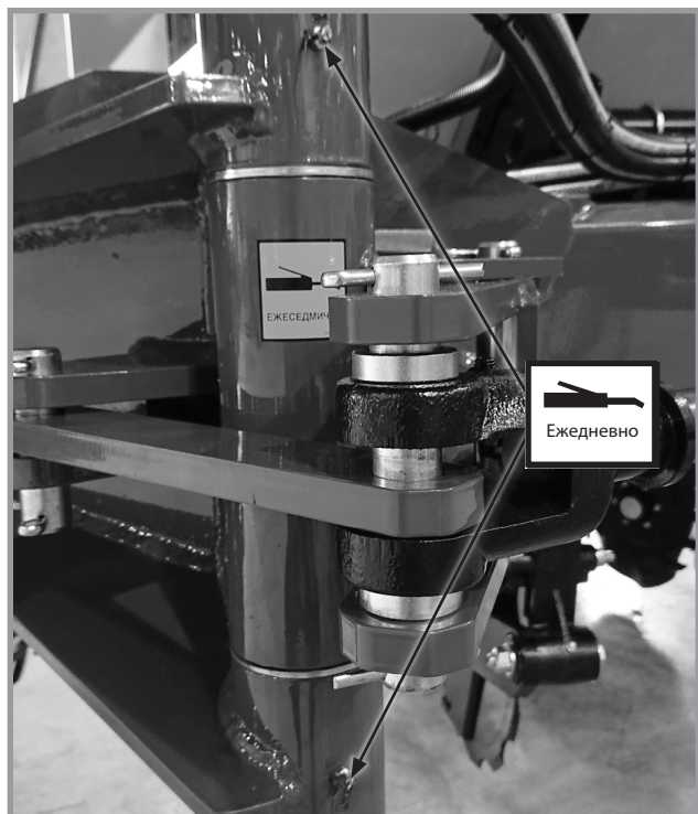
Шарниры крыла — по 2 на крыло
