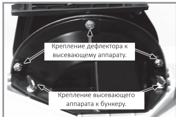
Снятие высевающего аппарата и дефлектора
