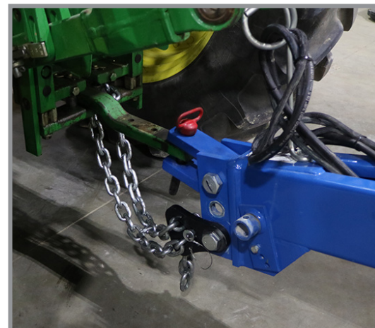
Соединение тягового бруса и предохранительной цепи
