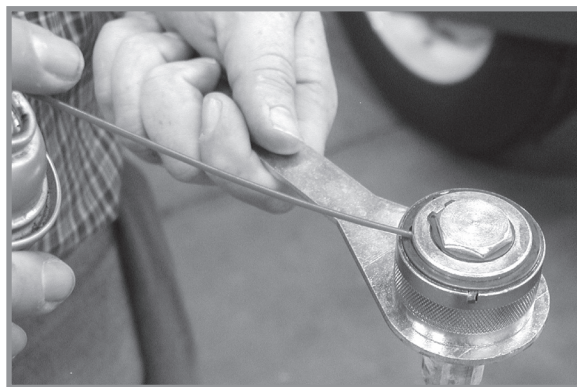
Смазка рычага с витой пружиной
