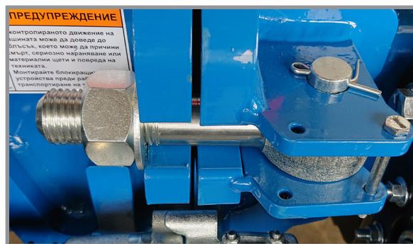
Затяжка фиксирующего крыло болта с кольцом
