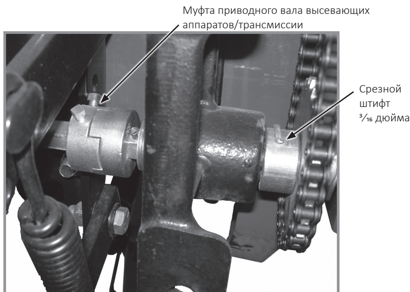
Муфта вала трансмиссии и приводного вала высевающих аппаратов
