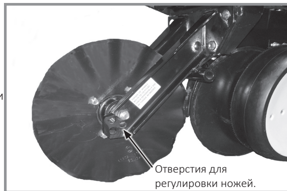
Дисковые ножи для нулевой обработки почвы, устанавливаемые на высевальные секции
