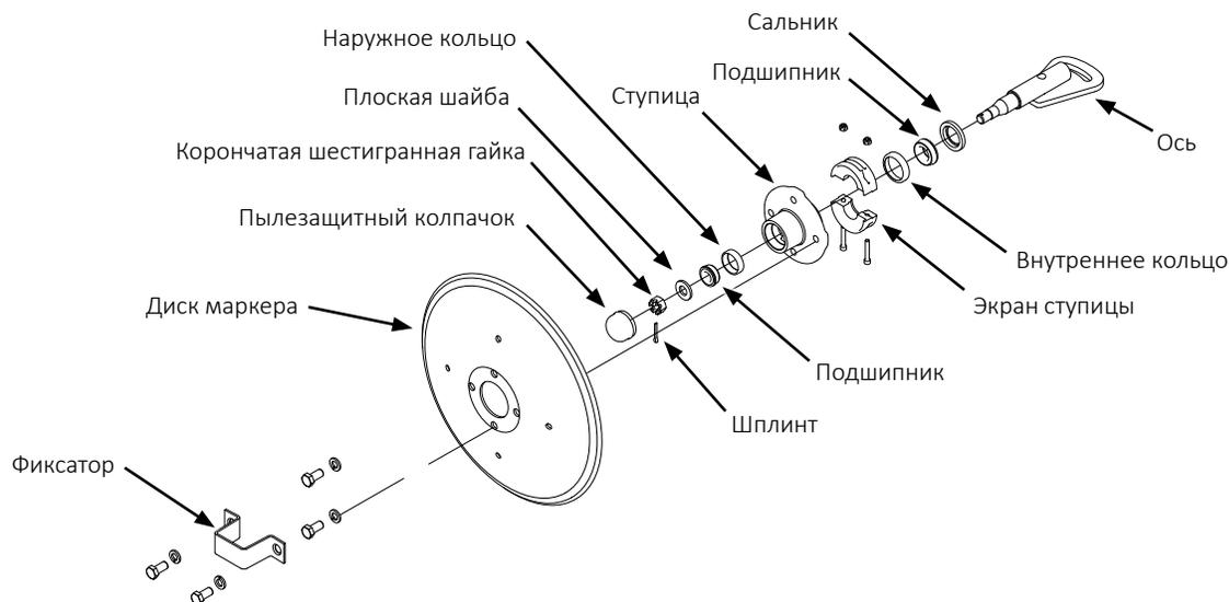
1. Снимите фиксатор и диск маркера.
