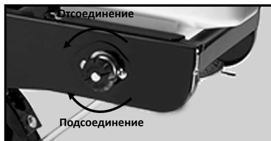
**Отсоединение привода для внесения гранулированных удобрений**
