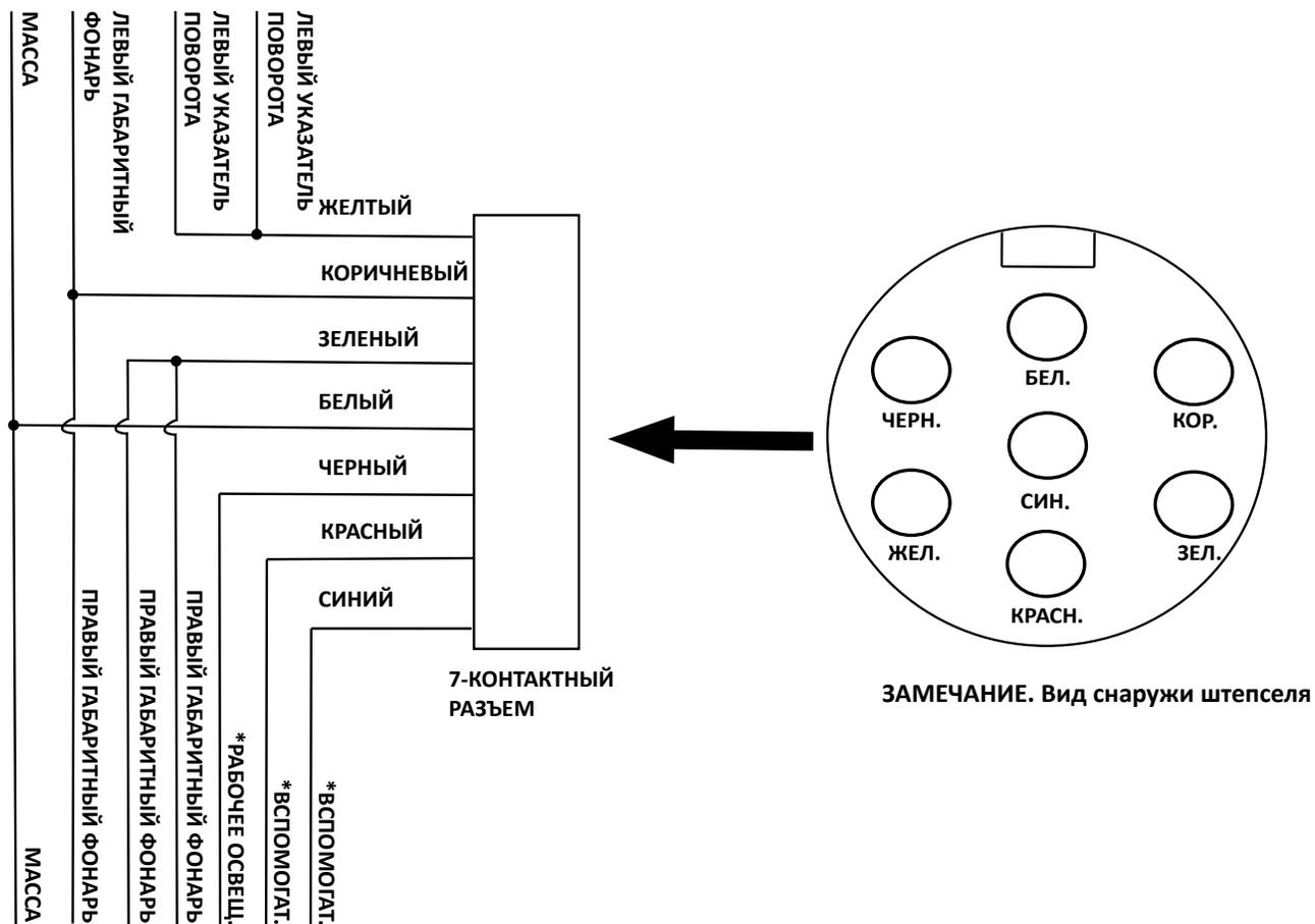
\* В существующие клеммы разъемов могут быть подключены провода и дополнительные световые приборы, приобретенные клиентом.
