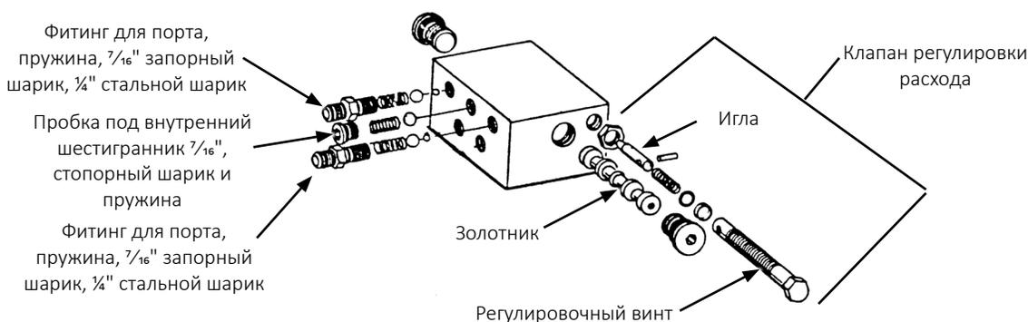
Блок клапанов содержит в едином узле клапаны последовательности и регулировки расхода маркеров. Часть клапана последовательности состоит из корпуса с камерами, в котором находится золотник и несколько обратных клапанов, обеспечивающих требуемое направление потока гидравлического масла.
