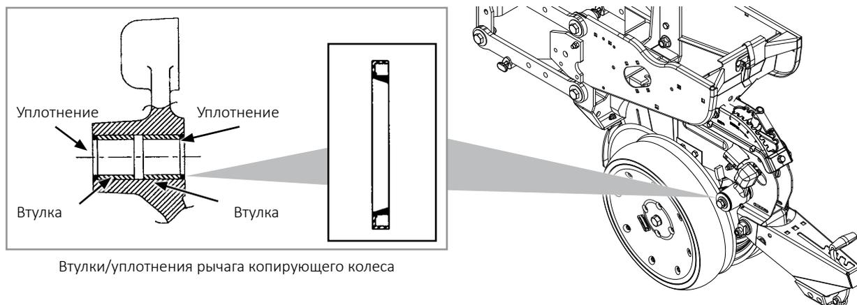
Втулки/уплотнения рычага копирующего колеса
