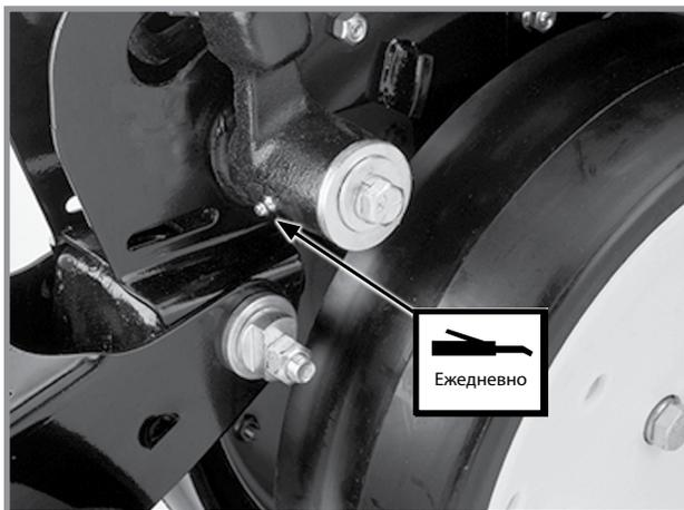
Рычаги копирующих колес — по 1 на рычаг
