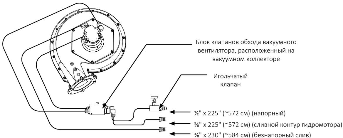
**ЗАМЕЧАНИЕ.** Если трактор оснащен выходом с регулированием потока (СКК), установите его в положение полного потока.
