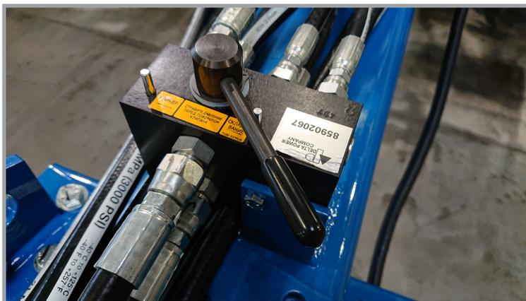
Устанавливаемый на дышле клапан переключения
