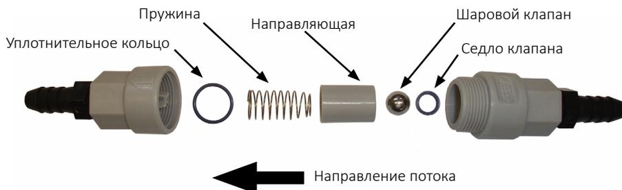
1. Разберите корпус, отвернув по резьбе, и отсоедините половины корпуса друг от друга. Отметьте ориентацию и расположение деталей.
