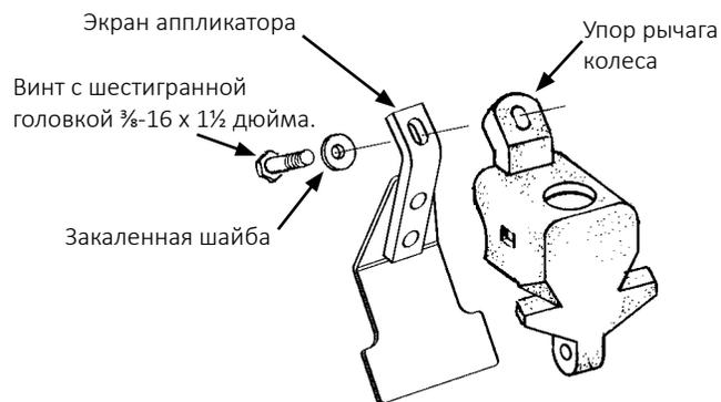
Установка экрана аппликатора для
