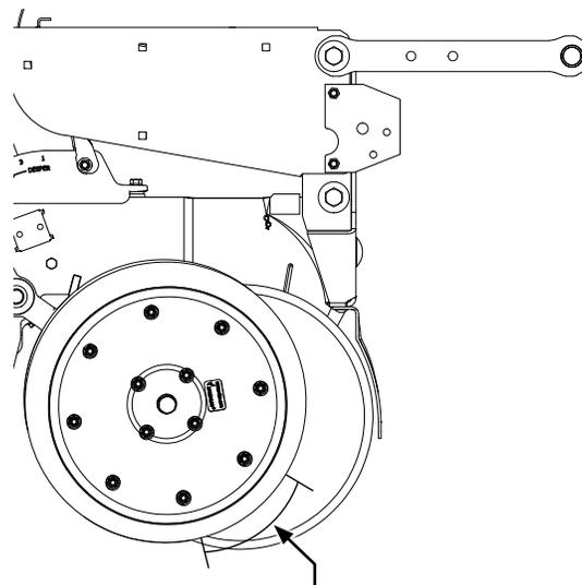
С помощью регулировочных шайб обеспечьте небольшой контакт дискового ножа сошника в данной области на дуге 10–15 см. Проверьте регулировку в рабочем положении.
