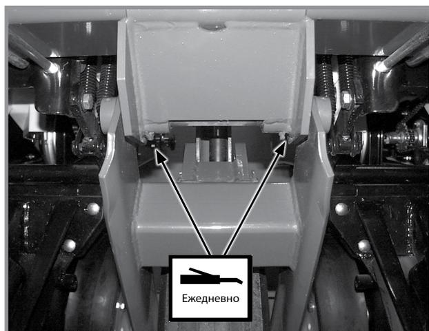
3. Колесный модуль — по 2 на модуль
