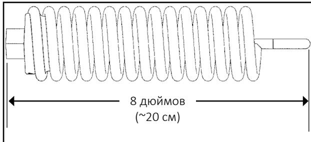
**Измерение длины пружины
