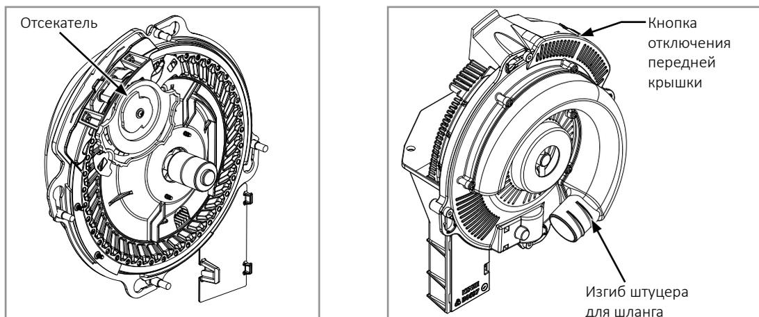
**ЗАМЕЧАНИЕ.** Наличие посторонних материалов в отверстиях высевающего диска, например фрагментов семян, их кожицы, стеблей и т. д., может отрицательно повлиять на подачу семян. Использование чистых семян обеспечивает точное дозирование вакуумным высевающим аппаратом. Ежедневно снимайте высевающие диски, чтобы убедиться в отсутствии скопления посторонних материалов в отверстиях дисков.
