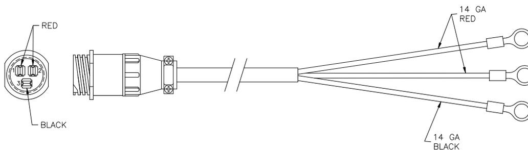
**ЖГУТ ПРОВОДОВ СЕЯЛКИ С ПЫЛЕЗАЩИТНЫМИ КОЛПАЧКАМИ**
