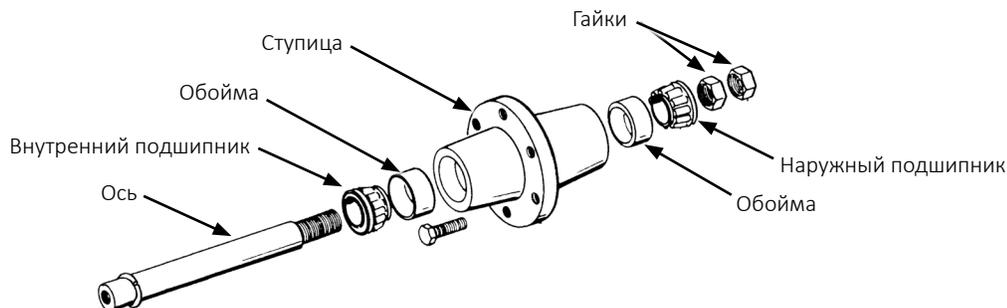
1. Поднимите колесо от земли и снимите колесо.
