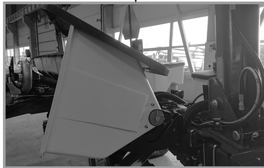
Поверніть кришку назад, а бункер - вперед
