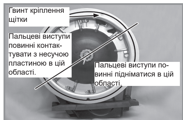
Правильна робота пальчикового висівного апарату
