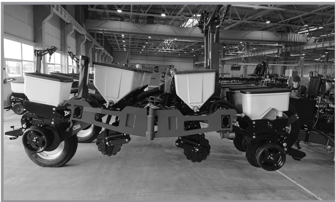
Встановлене додаткове обладнання для сухих добрив
