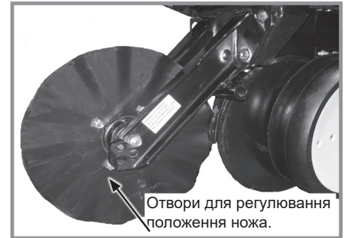
Отвори для регулювання положення ножа. Дискові ножі для нульової обробки ґрунту, що встановлюються на висівні секції
