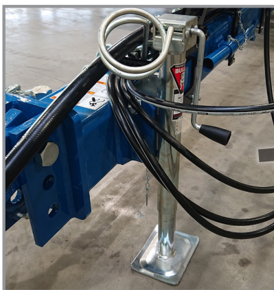
Встановлена підйомна опора
