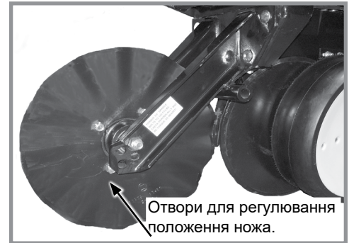
Дискові ножі для нульової обробки ґрунту, що встановлюються на висівні секції
