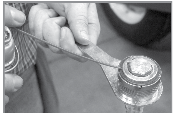
Змащування важеля з витою пружиною
