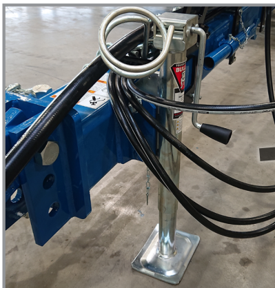
Встановлена підйомна опора
