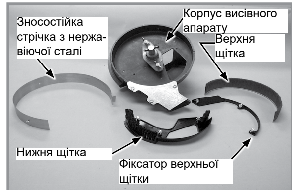
Деталі щіткового висівного апарату
