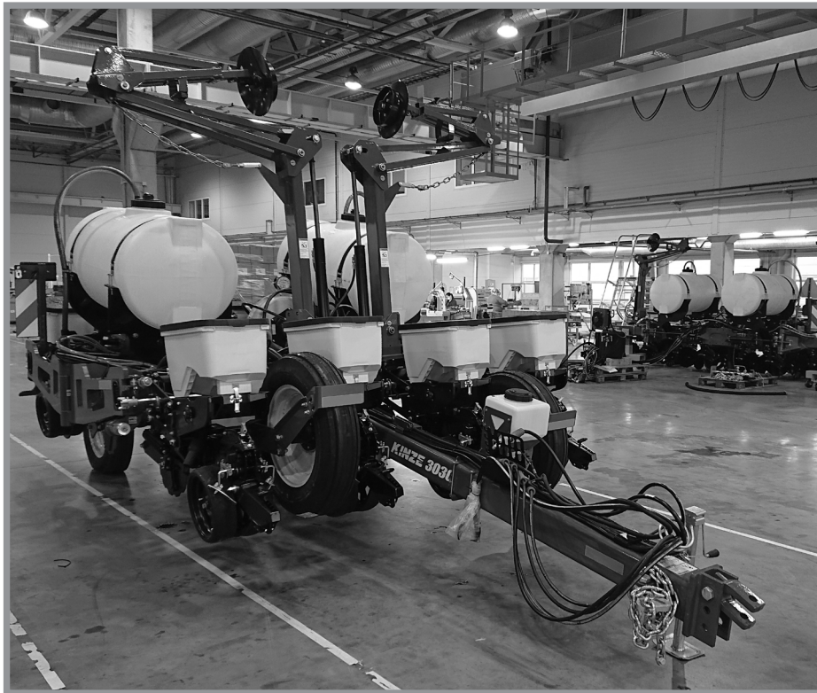
Встановлене додаткове обладнання для рідких добрив
