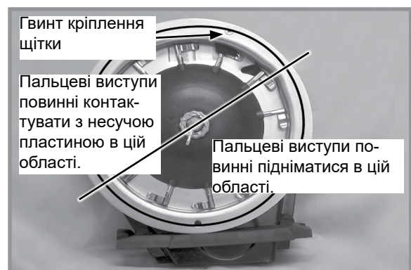
Правильна робота пальчикового висівного апарату
