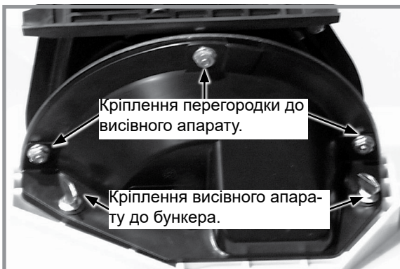
Зняття висівного апарату та перегородки
