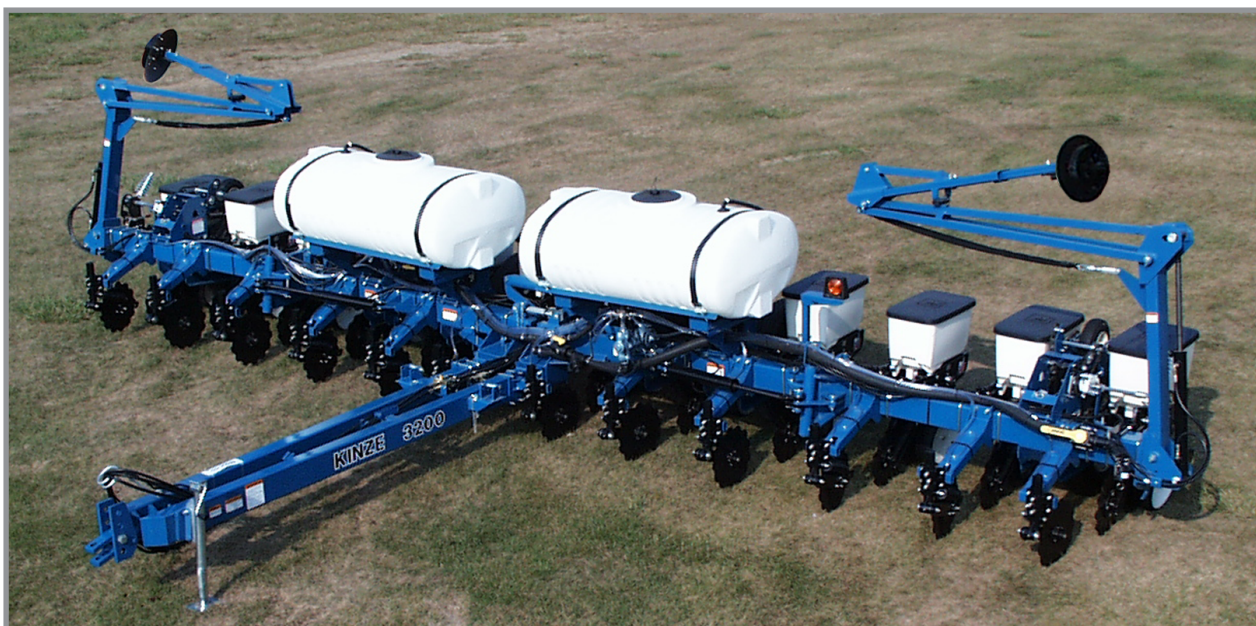
Установленное дополнительное оборудования для жидких удобрений
