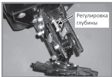
Регулировка глубины колес
