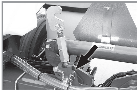
Стопорный штифт центральной стяжной винтовой муфты
