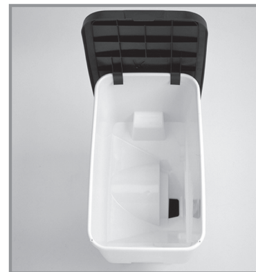
Бункер с механическим высевающим аппаратом
