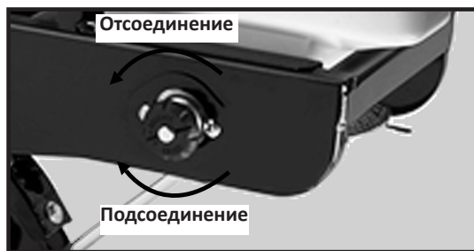
Отсоединение привода для внесения гранулированных химикатов
