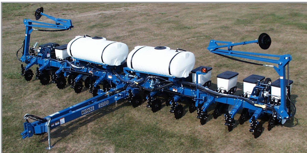
Установленное дополнительное оборудования для жидких удобрений
