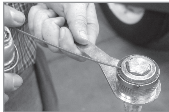
Смазка рычага с витой пружиной
