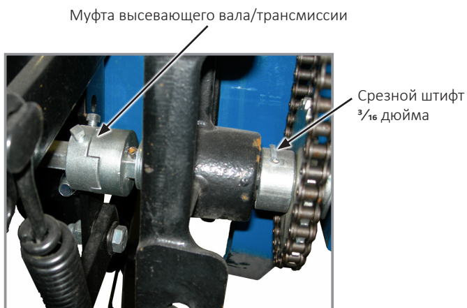
Муфта высевающего вала/трансмиссии Муфта вала трансмиссии и приводного вала высевающих аппаратов
