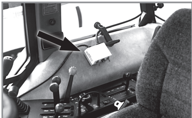
Пульт управления муфтой отключения указательного ряда
