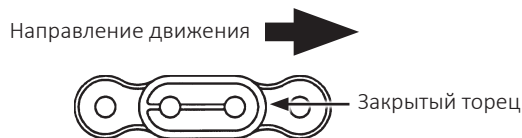
Привод вакуумного высевающего аппарата задней высевающей секции
