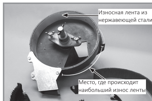
Износная лента из нержавеющей стали
