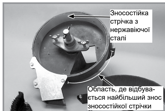
Зносостійка стрічка з нержавіючої сталі
