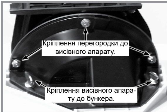
Зняття висівного апарату та перегородки
