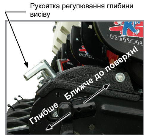
Регулювання глибини висіву
