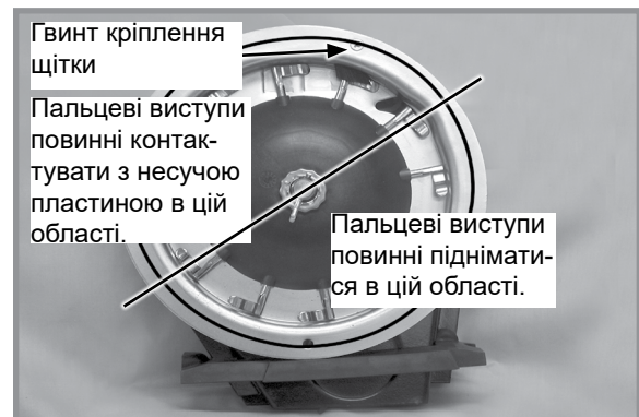
Правильна робота пальчикового висівного апарату
