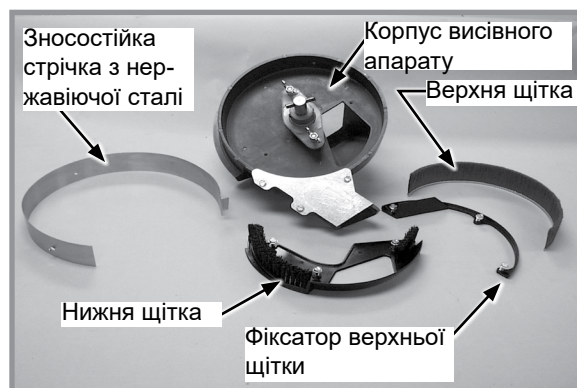
Деталі щіткового висівного апарату
