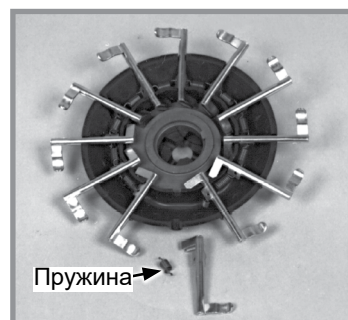
Пальчиковий висівний апарат для кукурудзи в зборі (Положення порожнини пружини відносно тримача)
