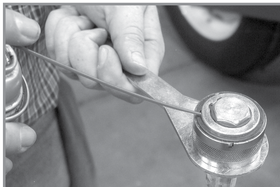
Змащування важеля з витою пружиною
