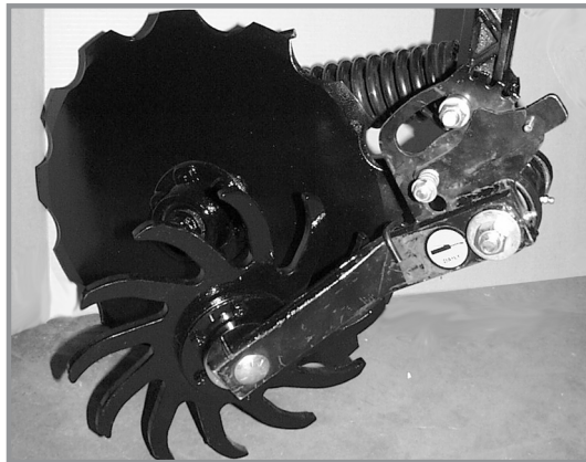
Обладнання у вигляді коліс для пожнивних залишків для зубчастого однодискового сошника
