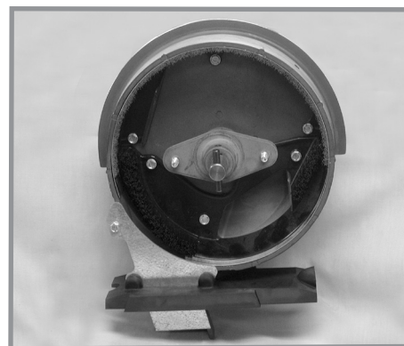
Показано без встановленого посівного диску
