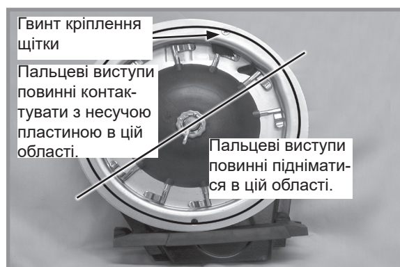
Правильна робота пальчикового висівного апарату
