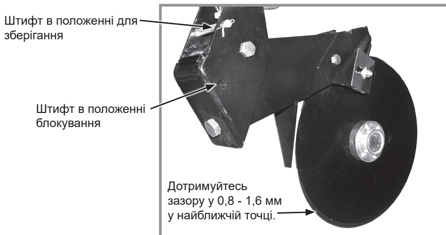
Дводисковий сошник для внесення добрив
