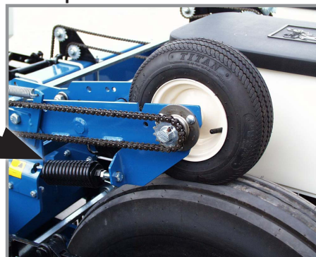
Местоположение на затягащата пружина
