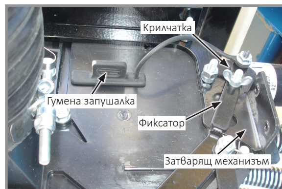
Механизъм за засмукване на система за зареждане на насипни материали (изглед отзад)
