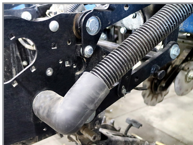
Спиране на вакуумен маркуч на система за разделяне на редовете
