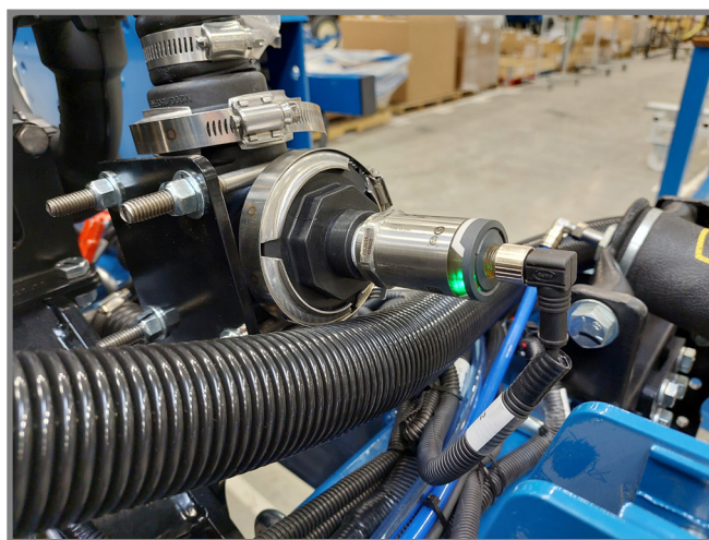
Сензор на линията за потока от помпата
