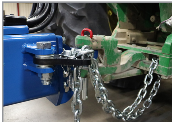
Свързване на теглич и предпазна верига
