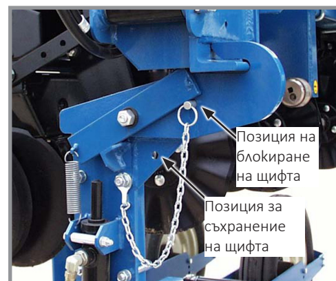
Позиции на блокиращия щифт на транспортния фиксатор
