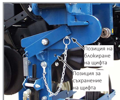
Позиции на блокиращия щифт на транспортния фиксатор
