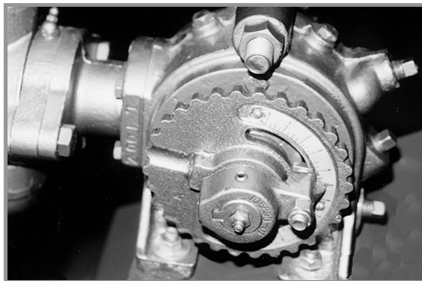
Бутална помпа за течен тор
