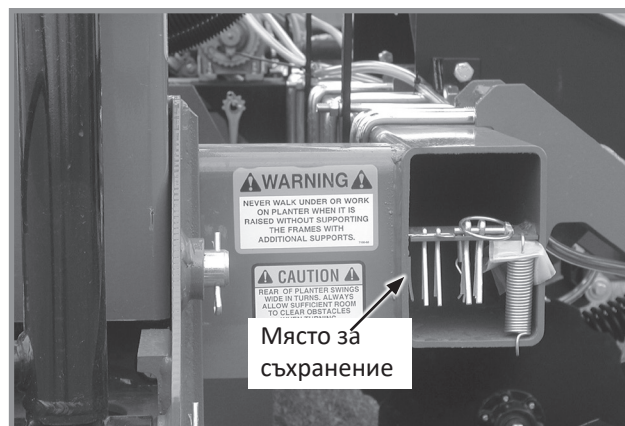
Място за съхранение на резервна брънка за верига
