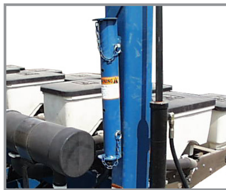
Монтирано блокиращо устройство на маркер Блокиращо устройство на маркер на мястото за съхранение
