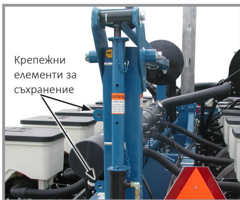
Монтирано блокиращо устройство на маркер Блокиращо устройство на маркер на мястото за съхранение
