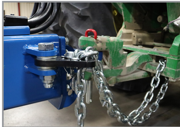
Свързване на теглич и предпазна верига
