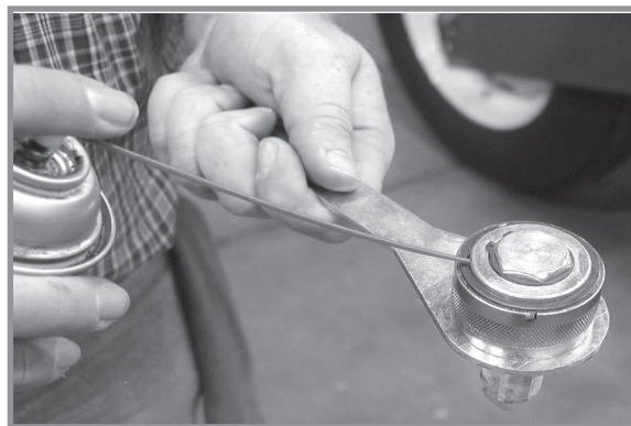
Смазване на ключ за навита пружина
