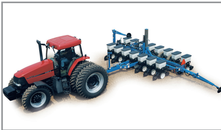
Модел 3505 със стандартни бункери и резервоари за сух тор
