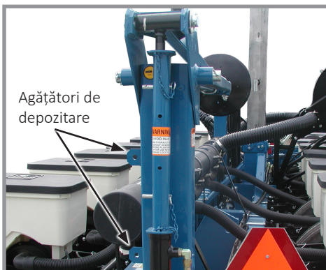
Dispozitivul de blocare al Marcatorului de rând instalat
