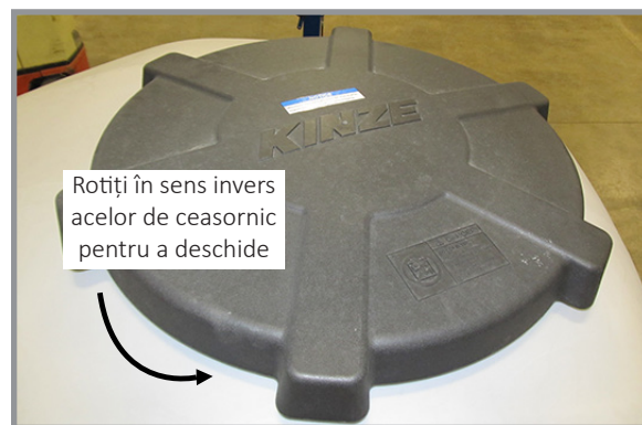
Clapa de blocare a rezervorului de umplere vrac
