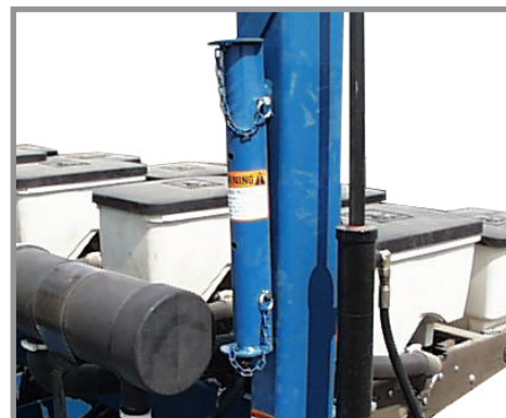
Dispozitivul de blocare al Marcatorului de rând în locația de depozitare
