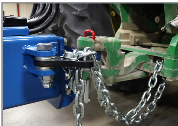
Conectarea barei de tracțiune și a lanțului de siguranță
