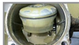
Ulei după diafragmă Ruptură
