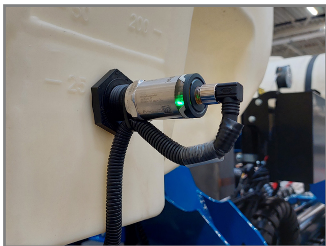
Senzor pe rezervorul de îngrășământ
