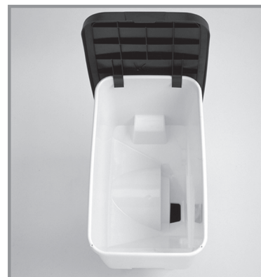
Pâlnia mecanică de încărcare a semințelor
