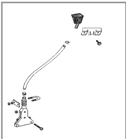
Întinzător cu compensarea pantei de 4½" (~11 cm)
