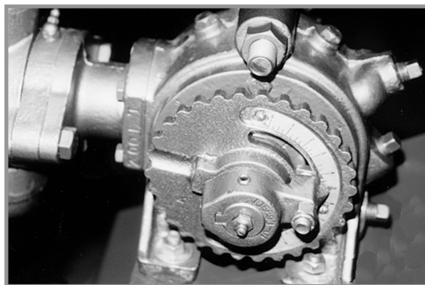
Pompa cu piston pentru îngrășământ lichid
