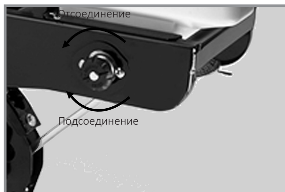
Отсоединение привода для внесения гранулированных удобрений
