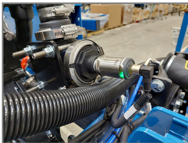
Датчик на магистрали насоса
