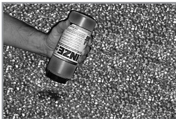
Добавление графита в центральный бункер для семян
