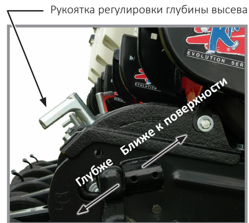
Регулировка глубины высева
