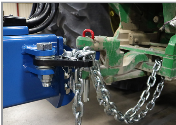
Соединение тягового бруса и предохранительной цепи
