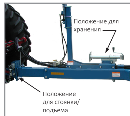
Места размещения домкратной стойки
