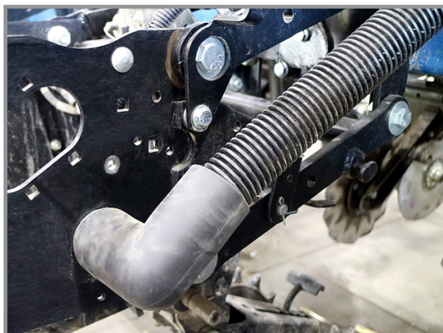
Отключение вакуумного шланга раздельного высева
