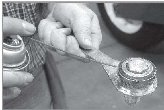
Смазка рычага с витой пружиной
