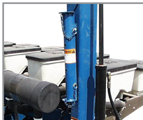
Стопорное устройство в положении для хранения
