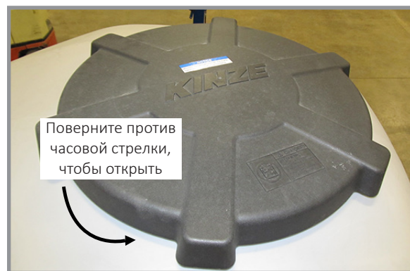
Крышка резервуара центрального бункера
