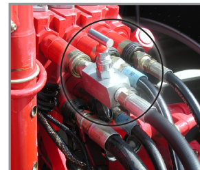
Комплект игольчатого клапана G1K426
