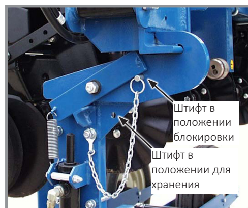
Места установки стопорного штифта транспортировочного фиксатора
