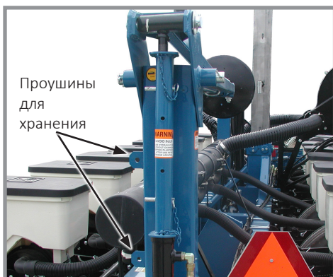
Установленное стопорное устройство маркера
