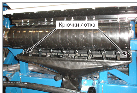
Установленный очистной лоток
