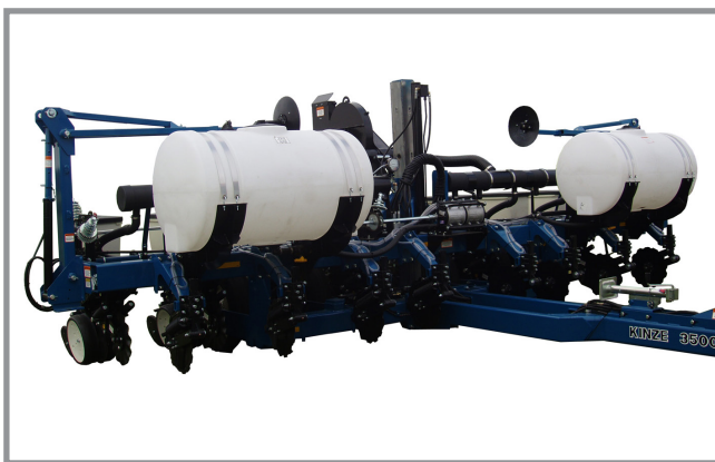
Установленное дополнительное оборудования для жидких удобрений
