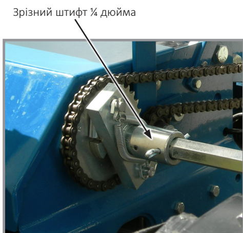
Привід системи внесення рідких добрив
