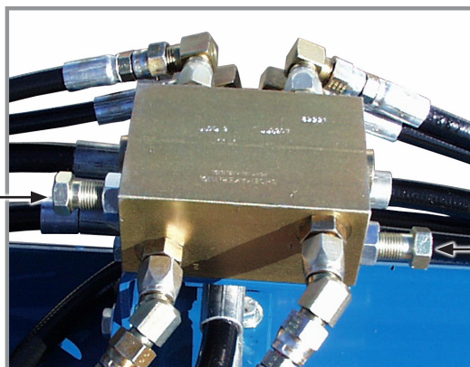
Клапан регулювання витрати маркерів
