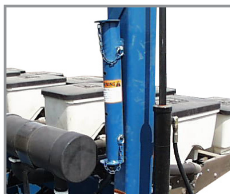
Блокувальний пристрій в положенні для зберігання
