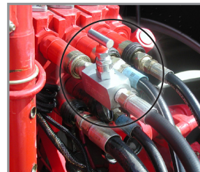
Комплект голчастого клапана G1K426
