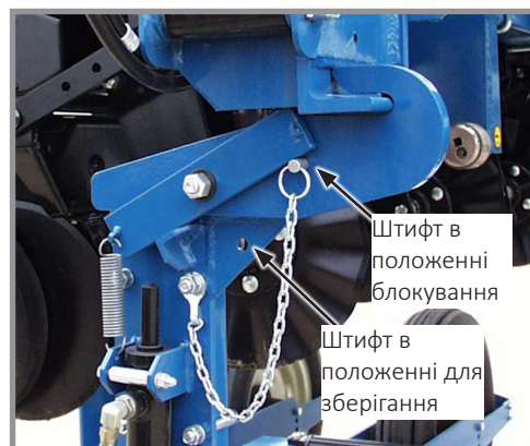
Місця встановлення блокувального штифта транспортувального фіксатора
