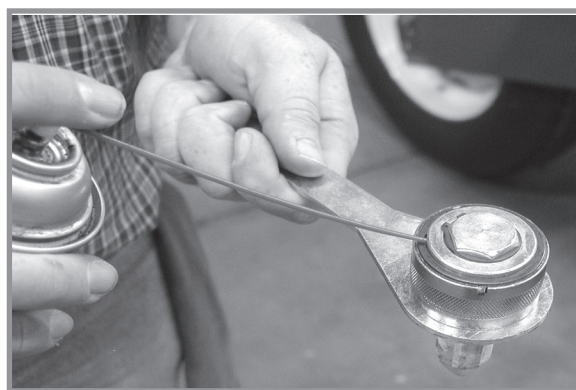
Мастило важеля з витою пружиною
