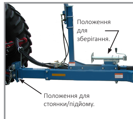
Місця розміщення домкратної стійки
