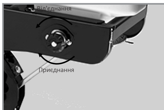
Розчіпний пристрій приводу для гранульованих хімікатів
