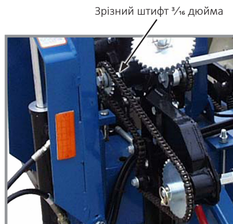
Привід системи внесення сухих добрив
