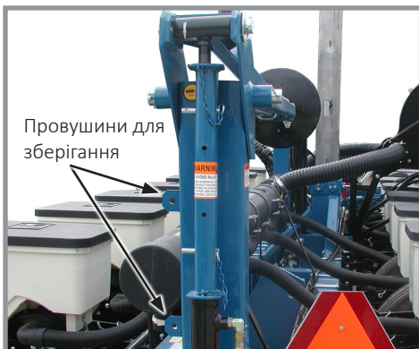
Встановлений блокувальний пристрій маркера
