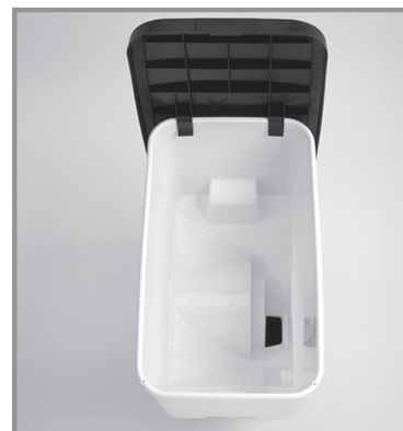
Бункер з механічним висівним апаратом
