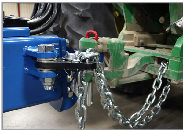
З'єднання тягового бруса і запобіжного ланцюга
