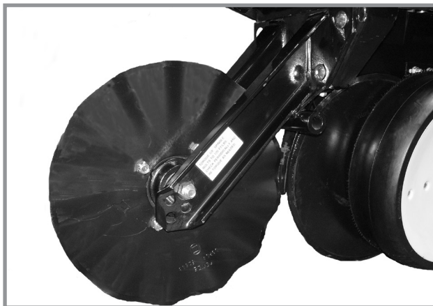
(Одна муфта для коліс для пожнивних залишків, що встановлюються на дискових ножах)
