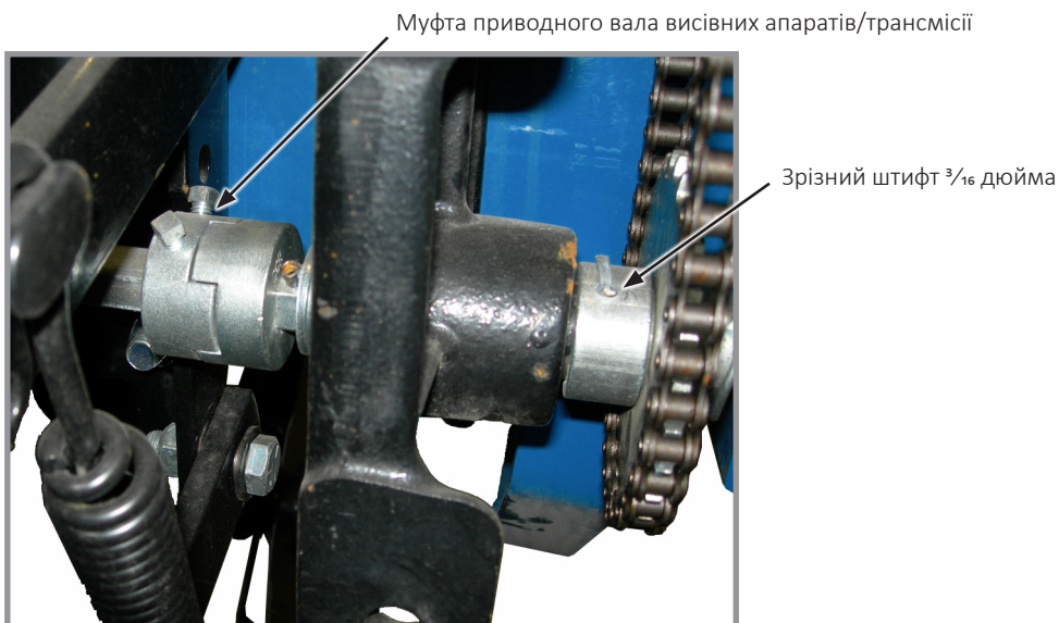
Муфта вала трансмісії і приводного вала висівних апаратів
