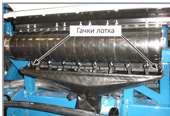
Встановлений очисний лоток
