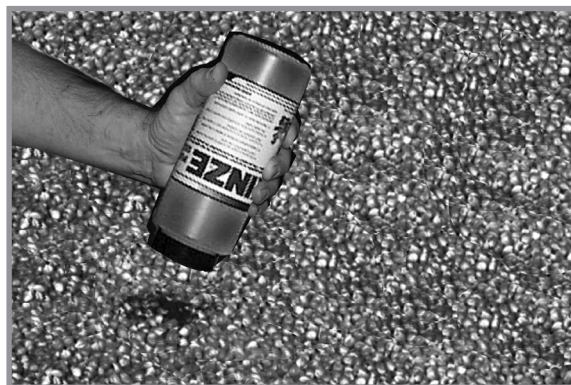
Додавання графіту в центральний бункер для насіння
