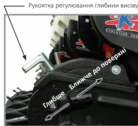
Регулювання глибини висіву
