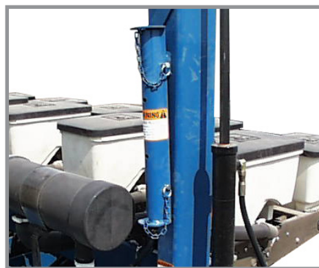
Блокувальний пристрій в положенні для зберігання
