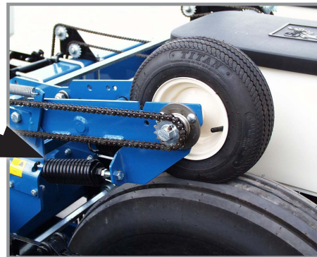
Розташування притискної пружини
