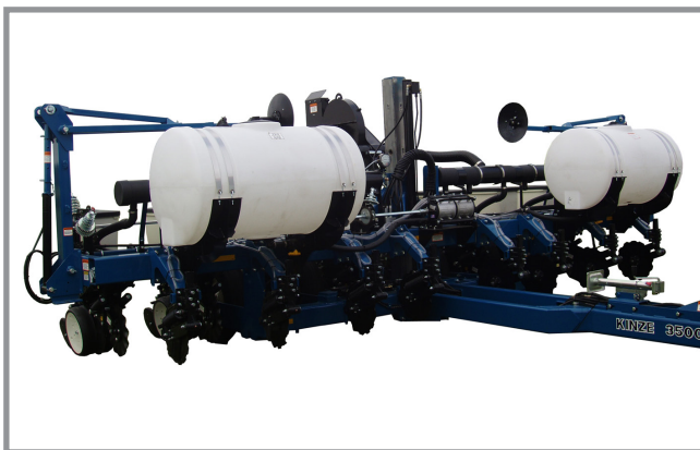
Встановлене додаткове обладнання для рідких добрив
