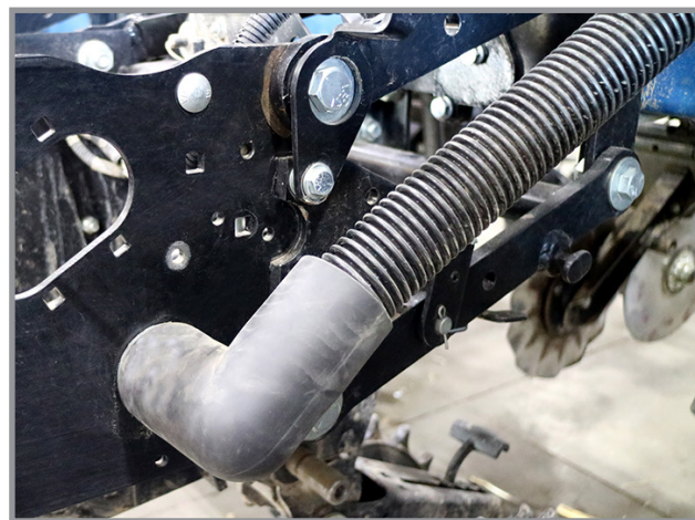
Відключення вакуумного шланга роздільного висіву
