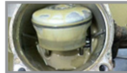
Масло след разкъсване на мембраната
