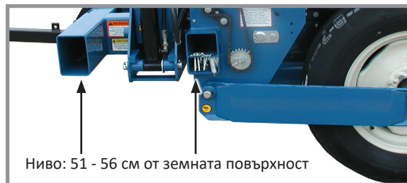
Нивелиране на рамата за инструменти на сеялката
