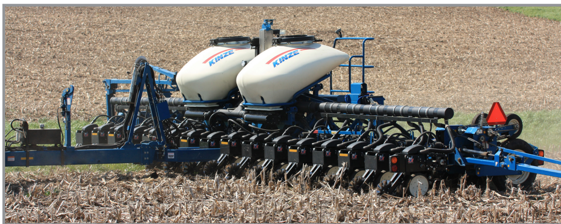
Модел 3605 е 16-редова сеялка с вакуумна система, разделно разпределяне на редовете и система за зареждане на насипни материали.
