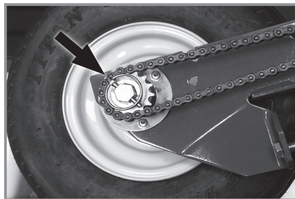
Опциональная ведущая звездочка с уменьшенным в 2 раза передаточным числом
