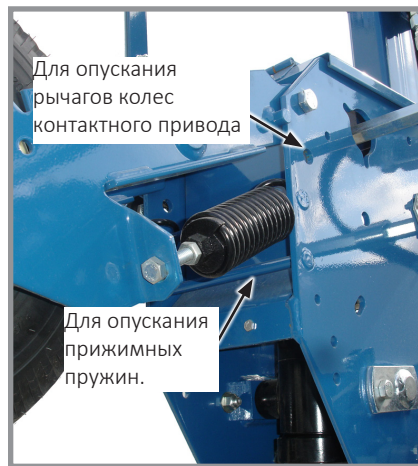
Регулировка колес контактного привода
