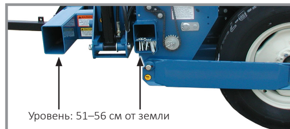
Выравнивание рам сеялки
