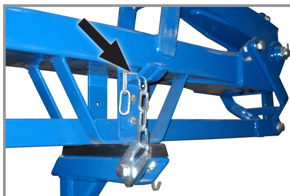
Установленное стопорное устройство маркера
