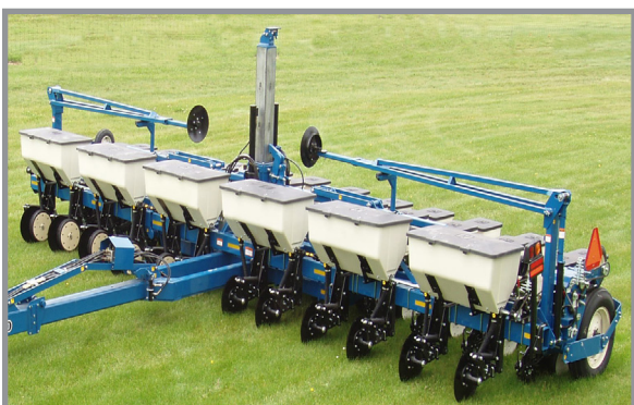
Установленное дополнительное оборудования для сухих удобрений
