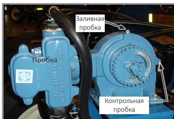
Расположение заливной и контрольной пробки поршневого насоса
