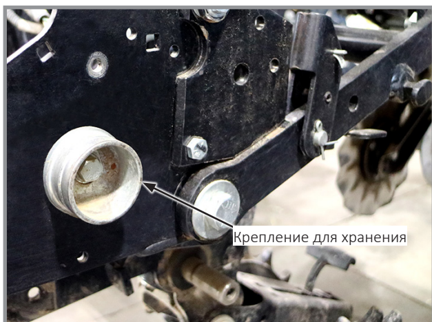
Отключение вакуумного шланга раздельного высева
