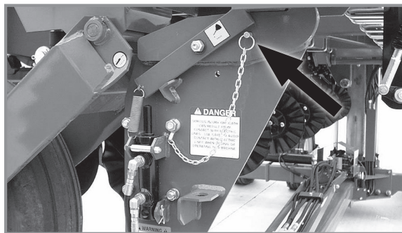
Установленный стопорный штифт транспортировочного фиксатора
