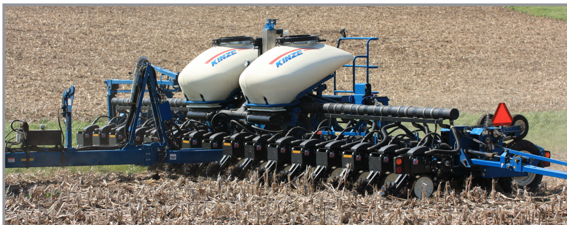
16-рядная сеялка модели 3605 с вакуумным высевальным аппаратом, разделительным высевом и системой центральных бункеров
