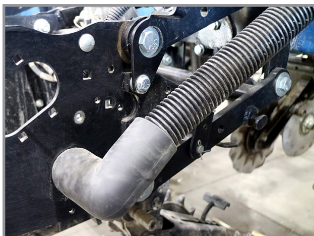
Отключение вакуумного шланга раздельного высева
