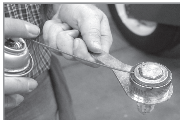
Смазка рычага с витой пружиной
