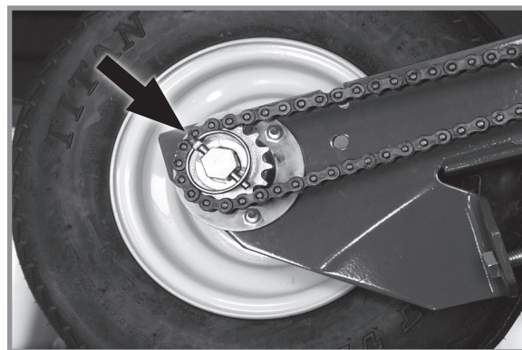
Оptionальная ведущая звездочка с уменьшенным в 2 раза передаточным числом
