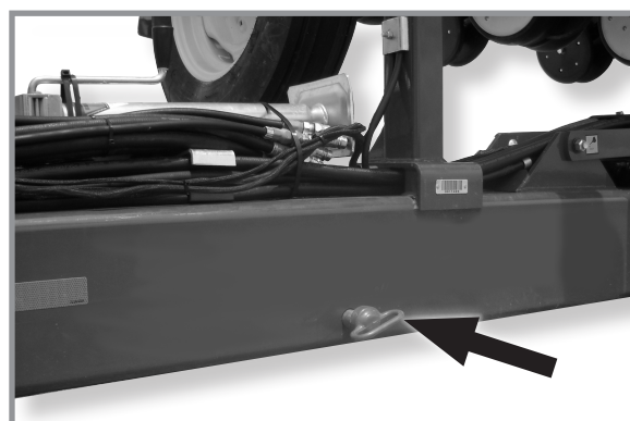
Предохранительный штифт дышла в положении для транспортировки
