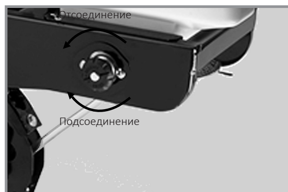
Отсоединение привода для внесения гранулированных химикатов
