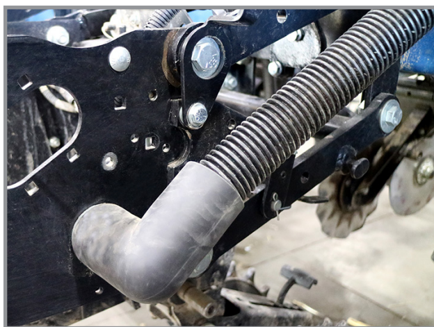
Отключение вакуумного шланга раздельного высева
