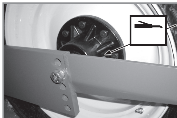
Подшипники транспортных колес — по 1 на ступицу
