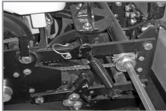
Дополнительные пружины фронтальной высевающей секции
