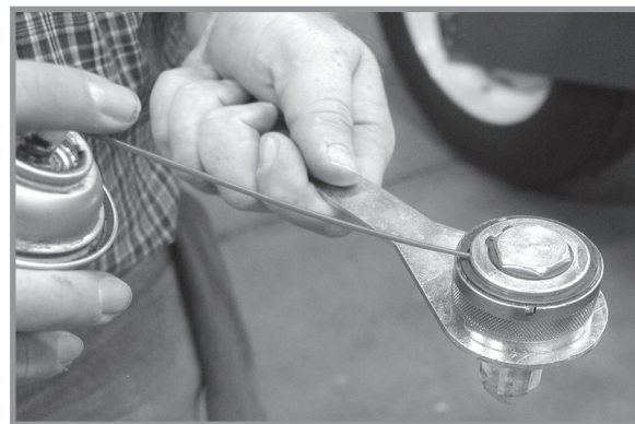
Смазка рычага с витой пружиной
