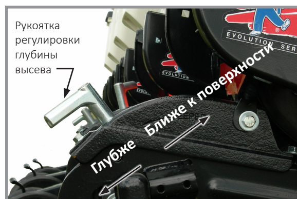
Регулировка глубины высева
