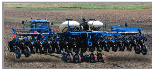
Поворот из транспортировочного положения в рабочее
