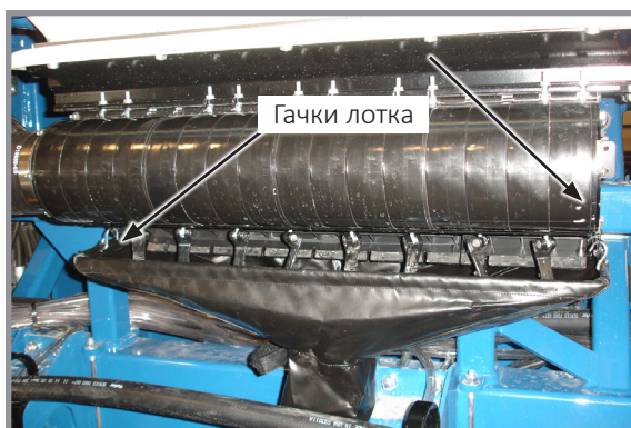
Встановлений очисний лоток
