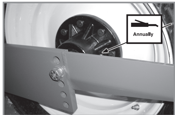
Підшипники транспортних коліс — по 1 на маточину
