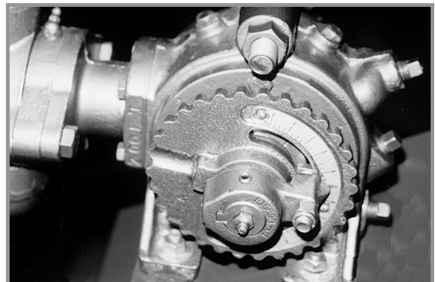
Поршневий насос для рідких добрив
