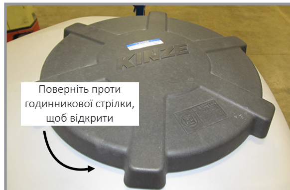
Кришка резервуара центрального бункера
