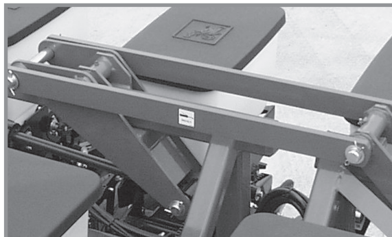
Стопорний пристрій крила
