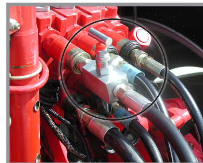
Комплект голчастого клапана G1K426
