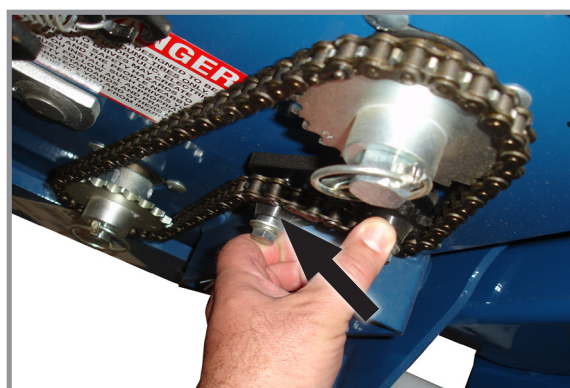
Регулювання натягу ланцюгового натягувача
