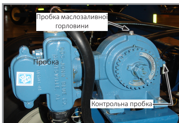
Розташування заливної та контрольної пробки поршневого насоса
