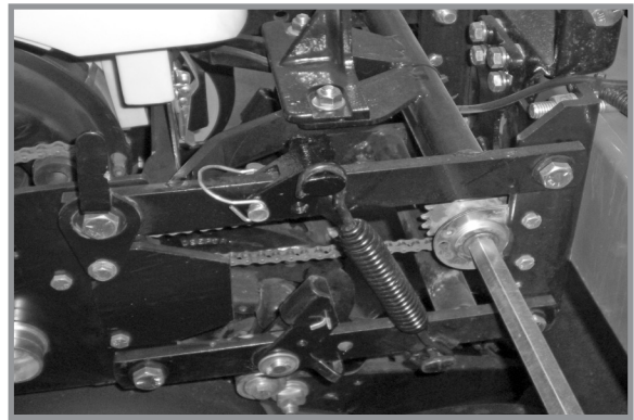
Допоміжні пружини фронтальної висівної секції
