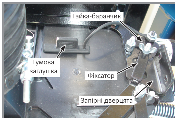
Розподільник системи центральних бункерів (вид з торця)
