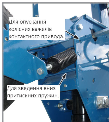
Регулювання коліс контактного привода
