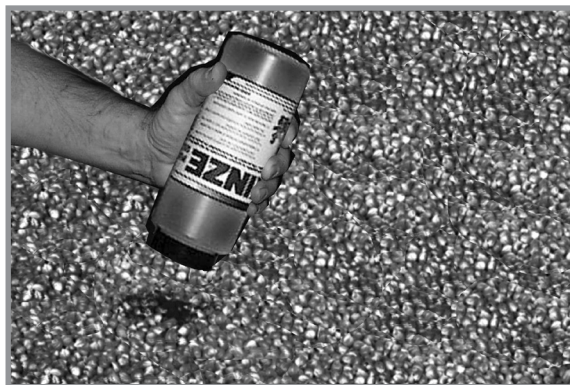
Додавання графіту в центральний бункер для насіння
