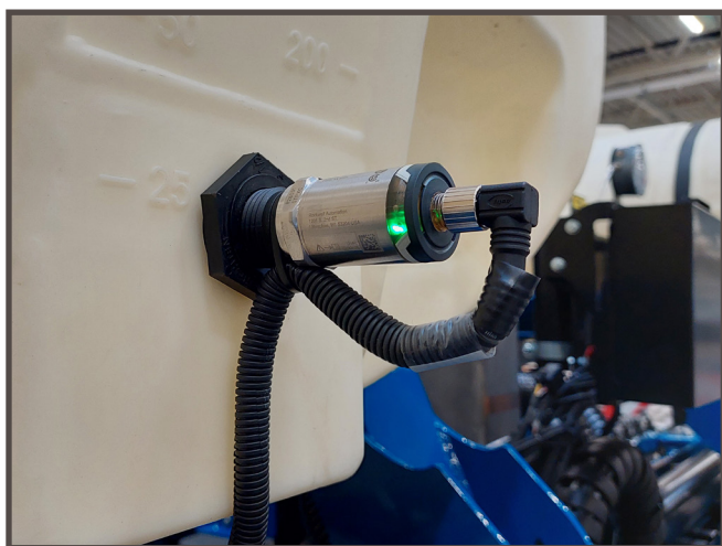
Датчик на баку для добрив
