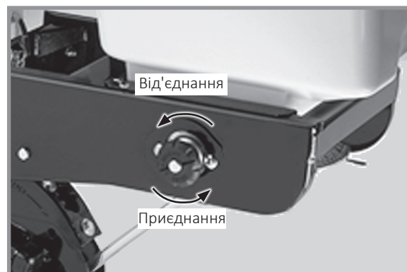
Ручка відключення подачі гранульованих хімікатів
