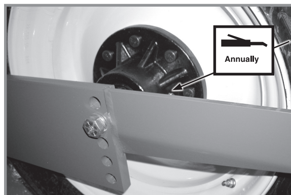
Підшипники транспортних коліс — по 1 на маточину
