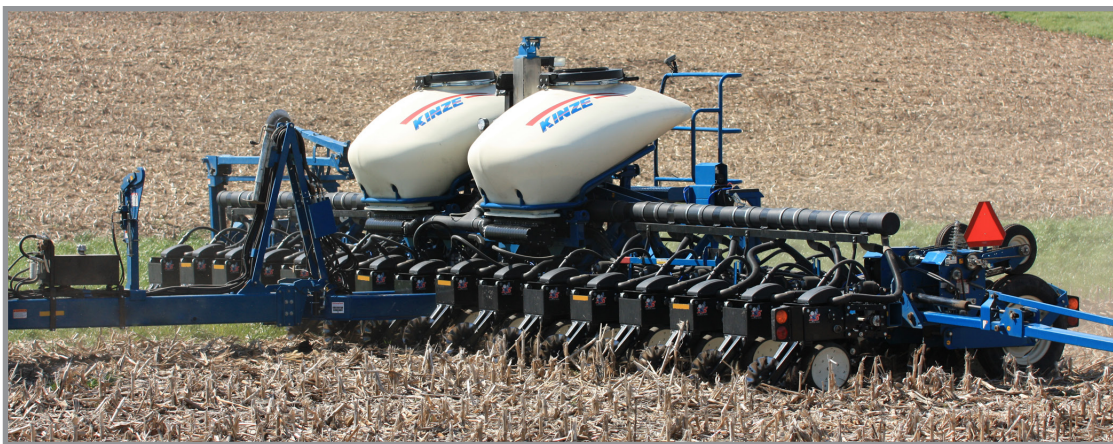
Сівалка на 16 міждрядь моделі 3605 з вакуумним висівним апаратом, роздільним висівом і системою центральних бункерів
