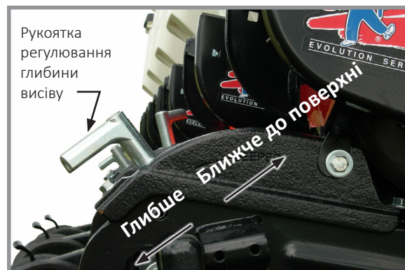
Регулювання глибини висіву
