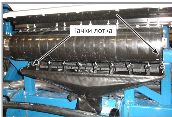
Встановлений очисний лоток
