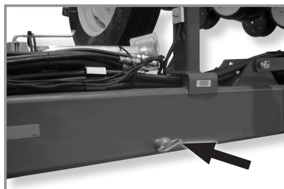
Запобіжний штифт тягово-зчіпного пристрою в транспортному положенні.
