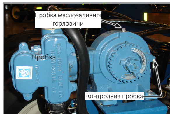
Розташування заливної та контрольної пробки поршневого насоса
