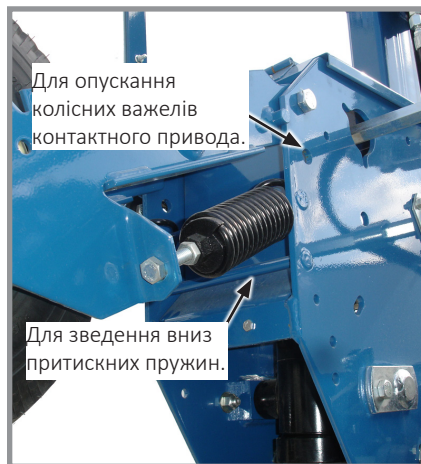
Регулювання коліс контактного привода
