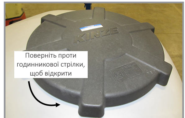
Кришка резервуара центрального бункера
