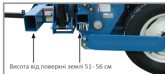
Вирівнювання рами сівалки
