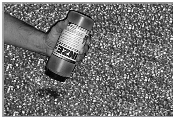
Добавление графита в центральный бункер для семян
