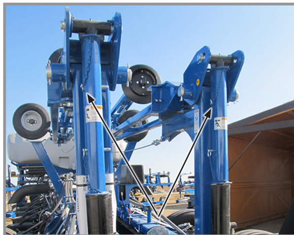
Установленное стопорное устройство маркера
