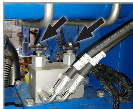
Регулировка органов управления скоростью маркеров
