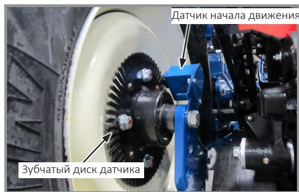
Датчик начала движения и зубчатый диск
