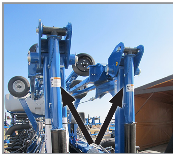
Установленное стопорное устройство маркера
