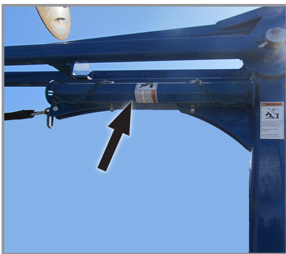
Стопорное устройство маркера в положении для хранения
