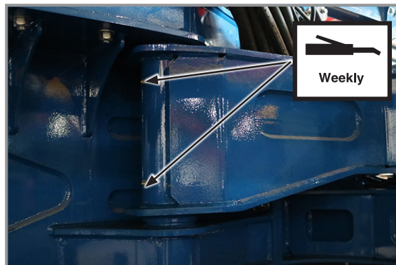
2. Поворотная ось, по 2 на сеялку, по 2 точки смазки на шарнир
