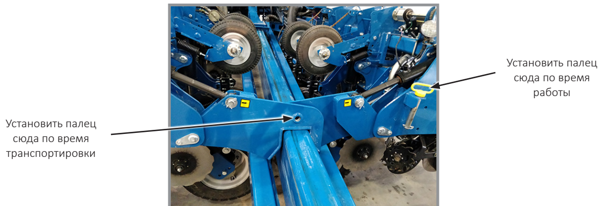
Снятие с дышла блокировки крюков крыльев
