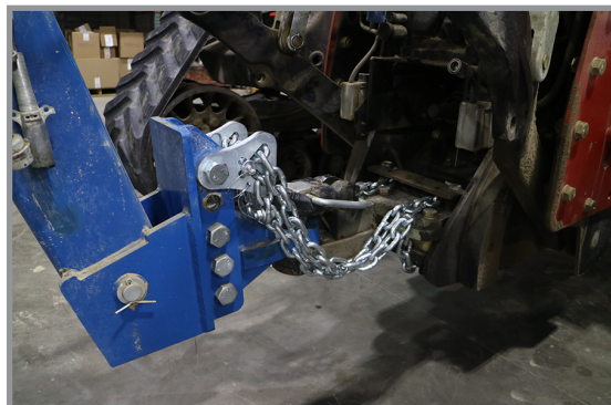
Присоединение предохранительной цепи к трактору и сцепке дышла
