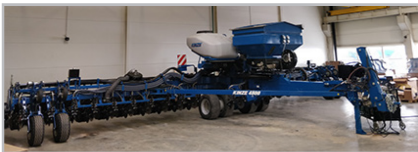
24-рядная сеялка точного высева модели 4805 с системой центральных бункеров
