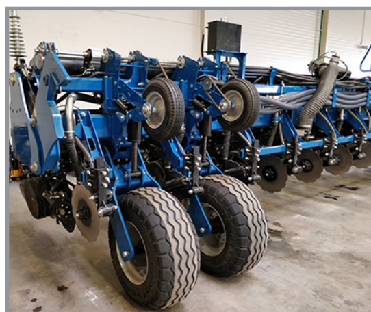
Колеса крыльев в положение для разворота в конце поля
