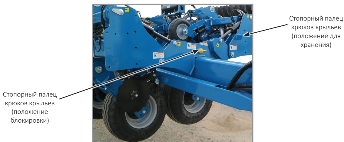
Установленная блокировка крюков крыльев
