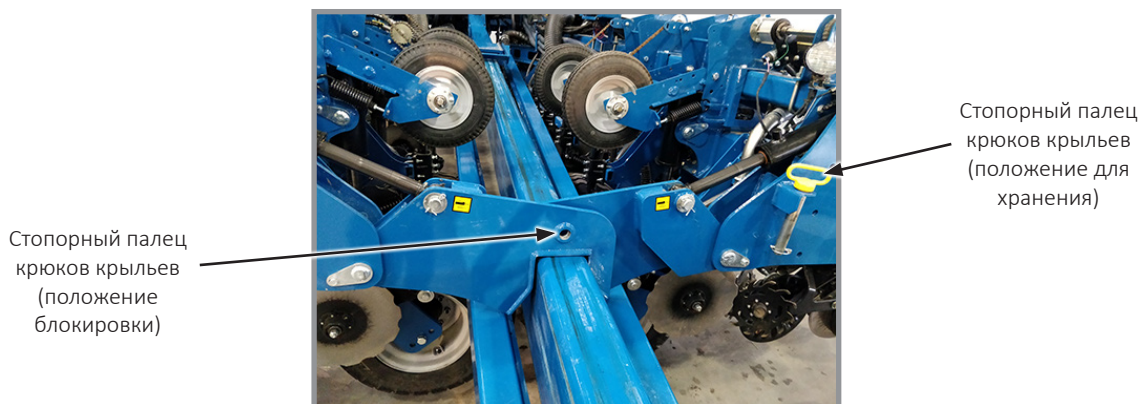
Снятие с дышла блокировки крюков крыльев
