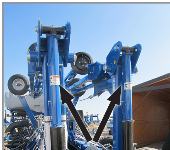
Встановлений блокувальний пристрій маркера
