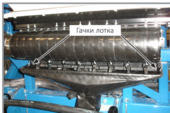
Встановлений очисний лоток
