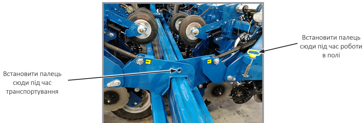
Від'єднання дишла від гаків крил
