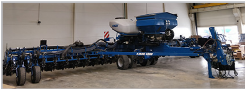
24-рядна сівалка точного висіву моделі 4805 з системою центральних бункерів
