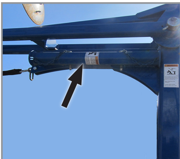
Блокувальний пристрій маркера в положенні для зберігання
