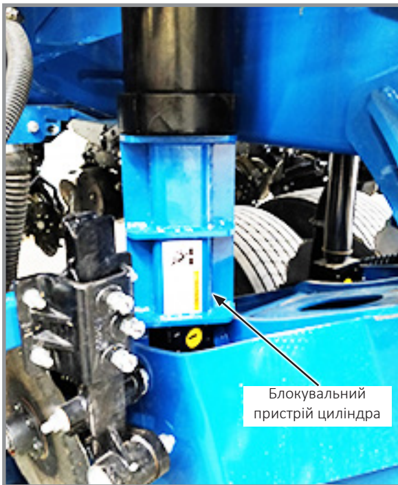
Встановлений блокувальний пристрій циліндра осі транспортних коліс
