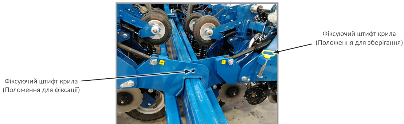
Від'єднання дишла від гаків крил
