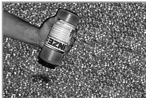
Додавання графіту в центральний бункер для насіння
