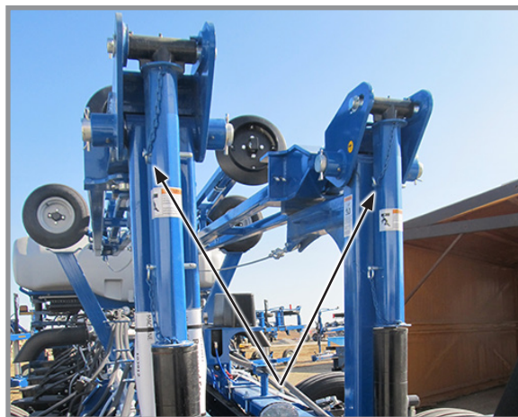
Встановлений блокувальний пристрій маркера
