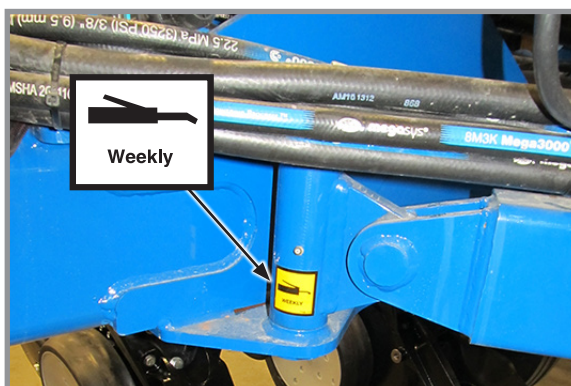
5. Draft Link, 2 per machine 1 fitting per link
