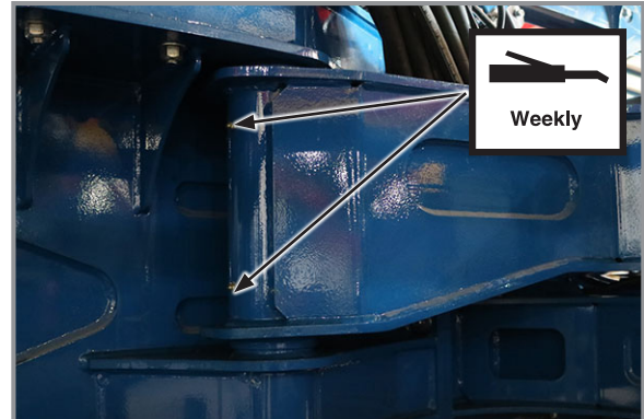
2. Fold pivot, 2 per machine 2 fittings per pivot
