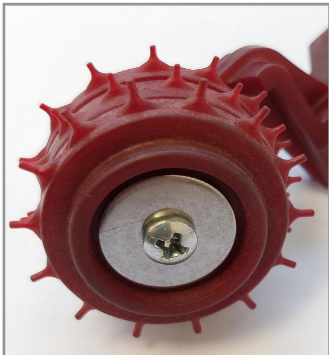
Выталкивающее колесо с исправными шипами
