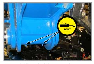
4. Wing pivot, 2 per machine 2 fittings per pivot
