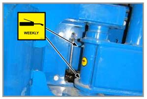
2. Fold pivot, 2 per machine 2 fittings per pivot
