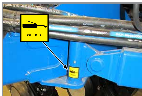
5. Draft Link, 2 per machine 1 fitting per link
