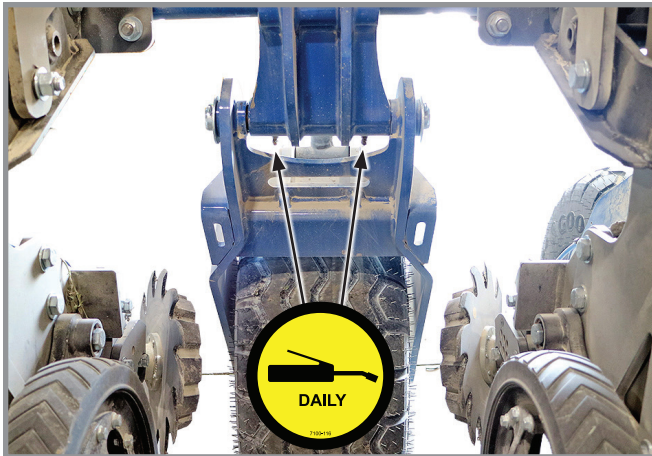
6. Wheel modules, 2 or 4 per machine 2 fittings per module
